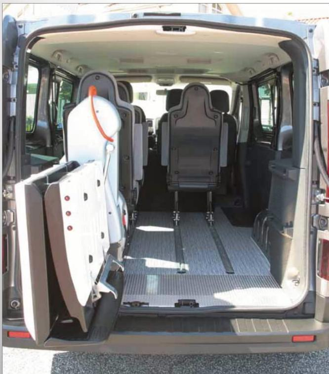
**SPACIEUX ET FLEXIBLE** Le tout nouveau Fiat Talento peut accueillir jusqu'à 3 positions de fauteuil roulant avec jusqu'à 5 configurations de sièges différentes. Le véhicule peut être configuré avec la banquette rabattable d'origine ou avec des sièges simples.
