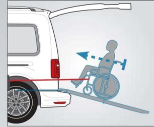
Le F-Winch Focaccia peut être installé pour faciliter l'entrée et la sortie de la personne en fauteuil roulant dans le véhicule. Le F-Winch permet de remonter / descendre le fauteuil roulant sur la rampe d'accès de manière confortable et sûre. Il peut être utilisé via une télécommande filaire standard ou la F-Télécommande sans fil.
